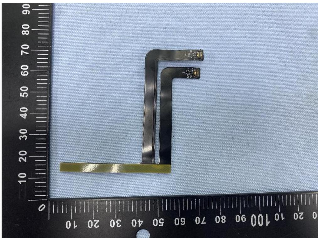
图六 保护电路板背面
